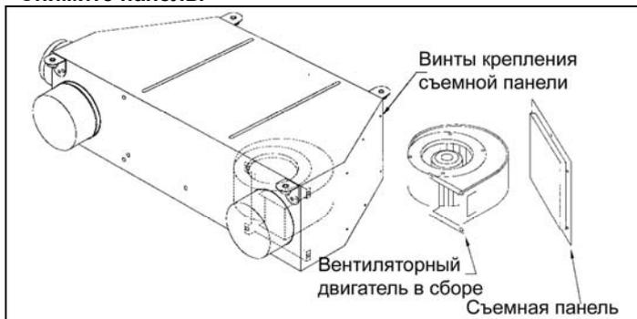
б) Отключите быстросоединяемые соединители силового кабеля вентиляторного двигателя.
