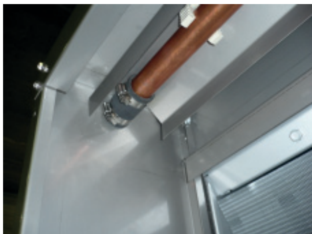
Соединение гибкого рукава
