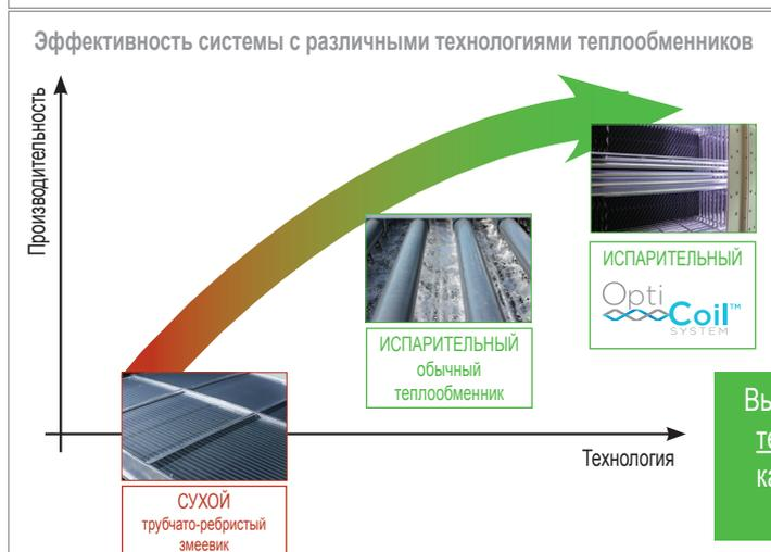
Высокоэффективный OptiCoil™ система повышает тепловой производительности до 30% по той же катушка объем опускания установлен мощность вентилятора до 50 %.
