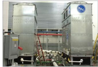
Лабораторные испытания доказали, что система OptiCoil™ уменьшает образование накипи.
