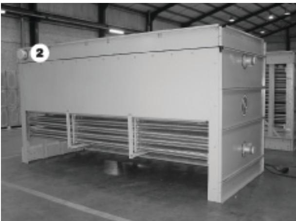
*Подсоединение трубопровода насоса на секции теплообменника*
