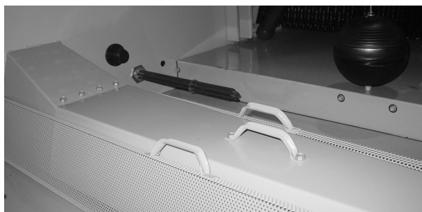
Бассейн холодной воды и сетчатый фильтр бассейна
