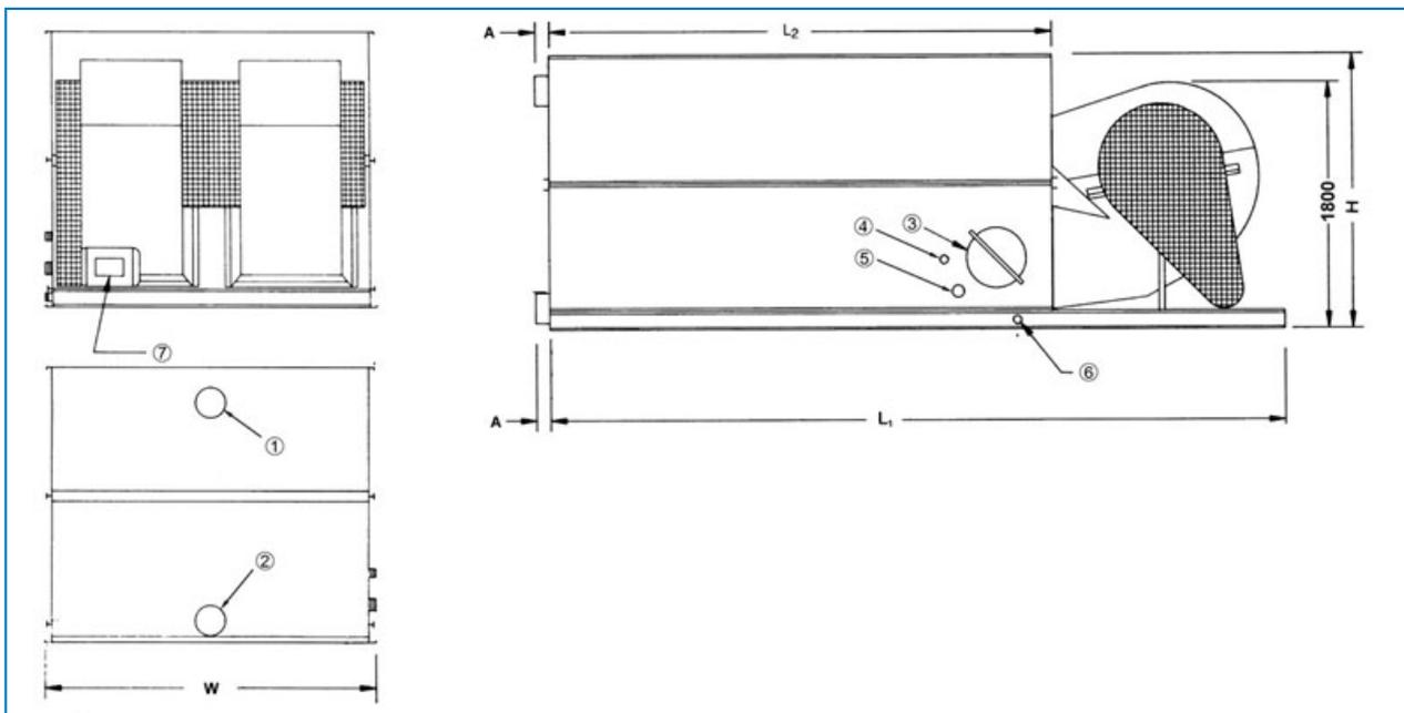
1. Впуск воды; 2. Выпуск воды; 3. Дверца люка; 4. Подпитка; 5. Перелив НД 80; 6. Слив НД 50. 7. Мотор вентилятора.
