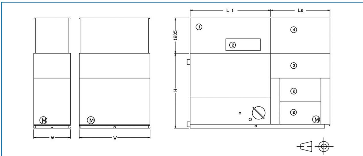
1. Выпускной шумоподавитель; 2. Дверца люка; 3. Впускной шумоподавитель; 4. Вентиляционная камера; H & W: высота и ширина изделия (см. технические данные).
