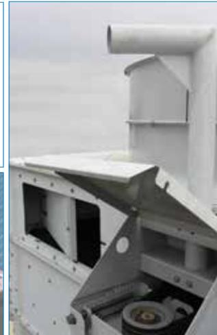
Скользкая внутри дверца люка. Мотор с наружными регуляторами и направляющими для демонтажа\*
